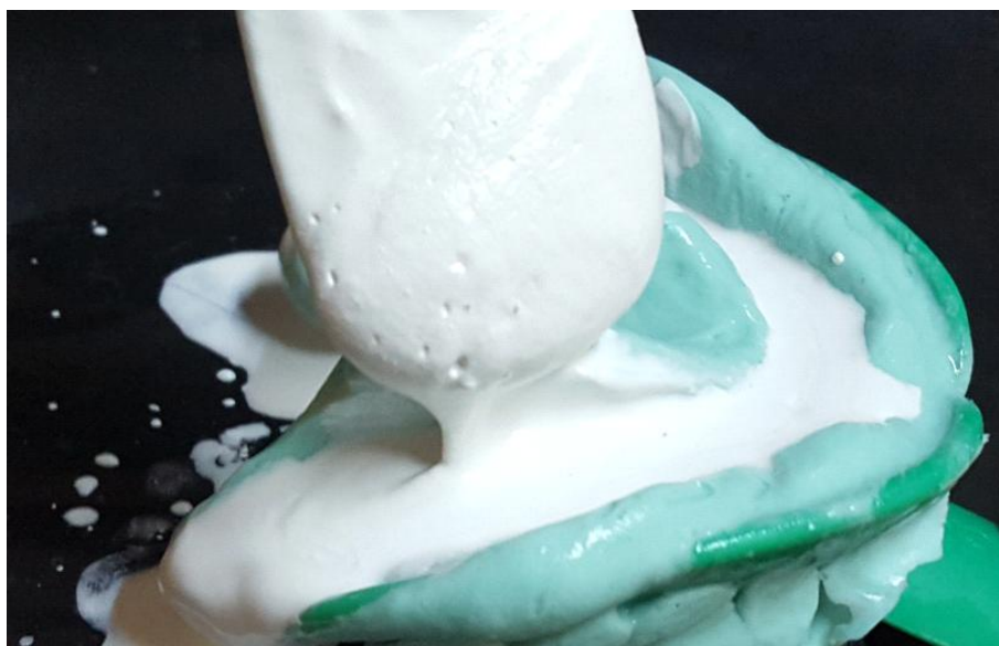
Fig. 4. Turnarea modelului din gips alb
