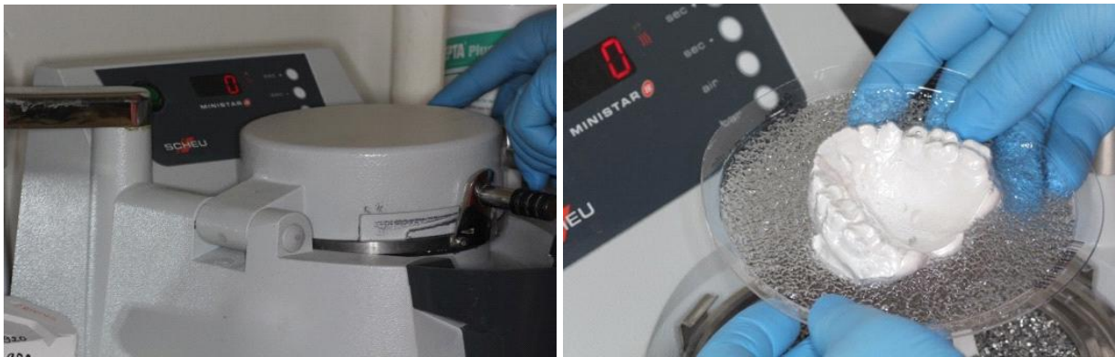
Fig. 9. Obținerea gutierei (după atingerea parametrilor optimi și a procesului de termovacuumformare)
