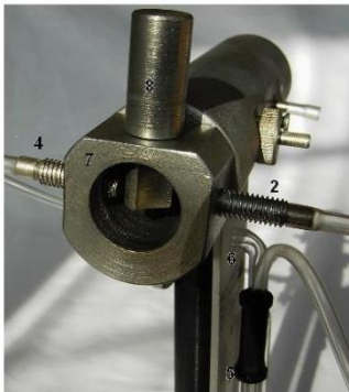
Fig.4.Vedere de ansamblu a aranjării elementelor suplimentare la dispozitivul de verificare a legii lui Bernoulli pentru evidențierea forței ascensionale.
